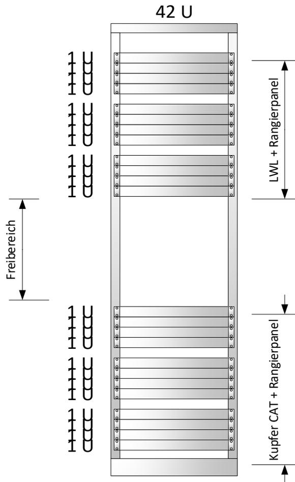
Abbildung 7:Abbildung Mischverkabelung
