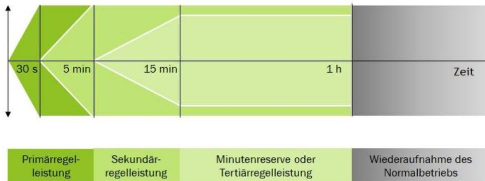
Abbildung 5-4: Aktivierungsgeschwindigkeiten und zeitliche Verfügbarkeit von Regelleistung (nach (Bundesnetzagentur (BNetzA) 2018)), IEE 2019
