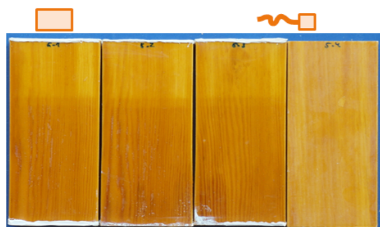
Abb.: Lasur nach 2016 h QUV-Bewitterung nach DIN EN 927-6
