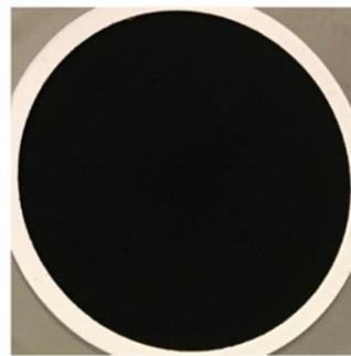
Probe eingesammelt auf einem Quarzfilter aus einem Abbrand, wenn der Partikelabscheider aus ist - 1.75 kg Holz verbrannt
