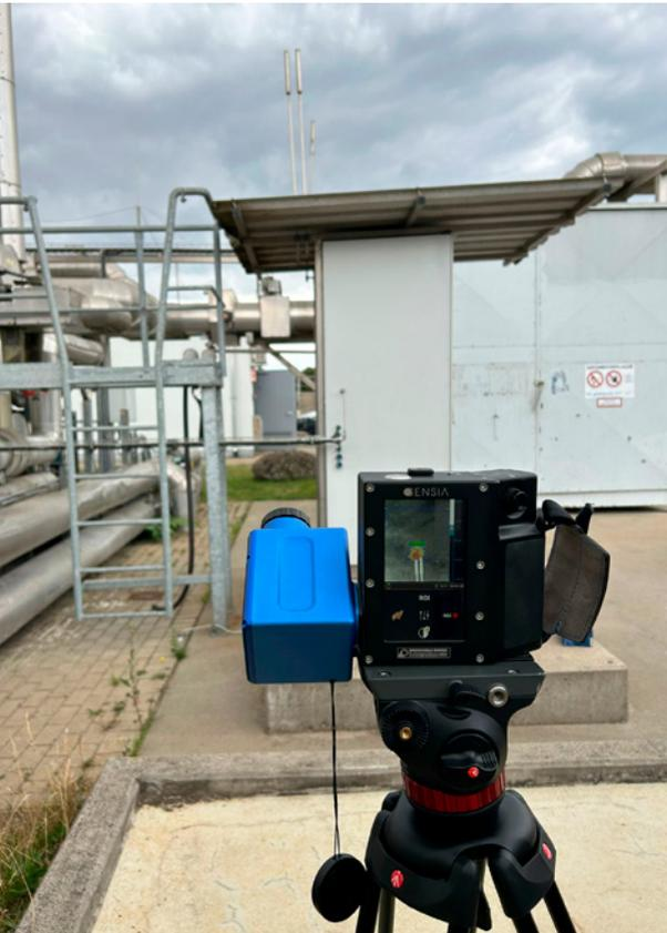
**Abb. 23:** Erfassung und Quantifizierung von Methanemissionen mittels q-OGI Gaskamera an einer Überdrucksicherung
