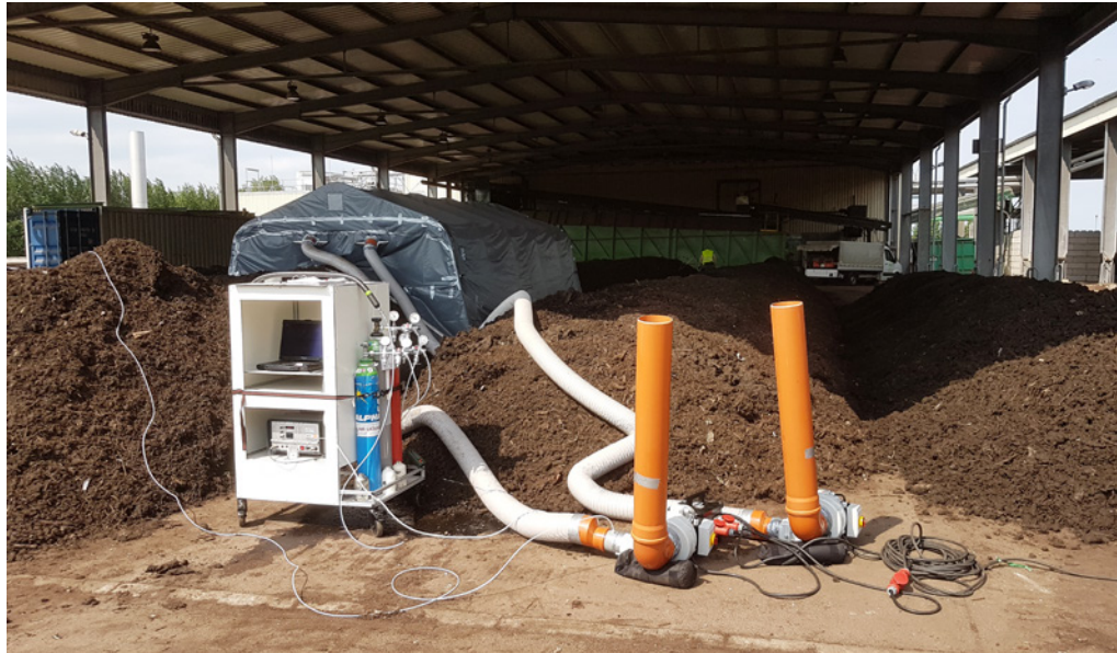
Abb. 23: Versuchsaufbau der Windtunnelmessungen mit Nutzung des FID an der Rotte der Vergärungsanlage A04 im Juni 2019
