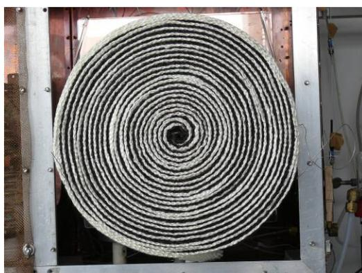
Abbildung 111: Foto der Katalysatorscheibe, nachdem das Isolierband mit eingewickelt wurde.
