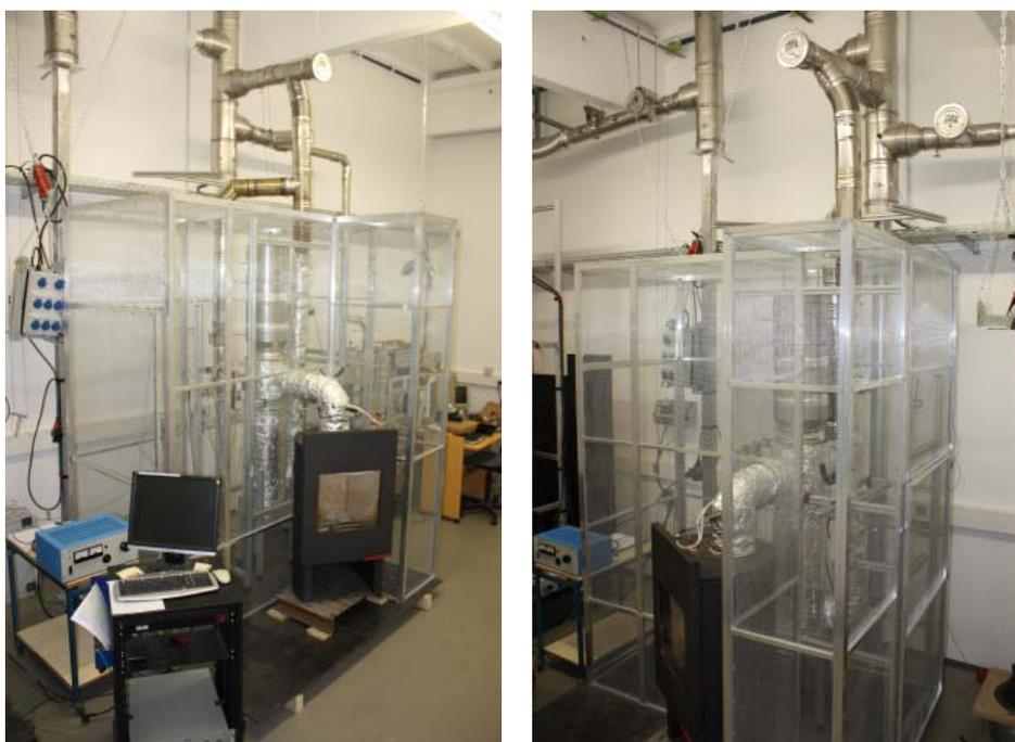
Abbildung 108: Technikumsversuchsanlage mit faradayschem Schutzkäfig
