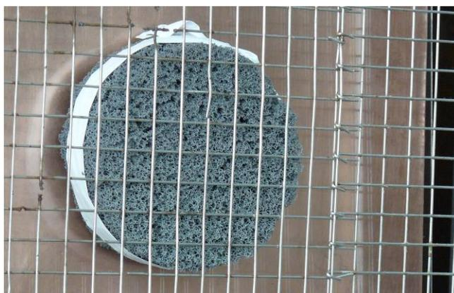
Abbildung 57: Al/Al<sub>2</sub>O<sub>3</sub>-Schaum zwischen der spannungsführenden Kupferelektrode und der geerdeten Gitterelektrode. Die Maschenweite des Gitters beträgt 11 mm.
