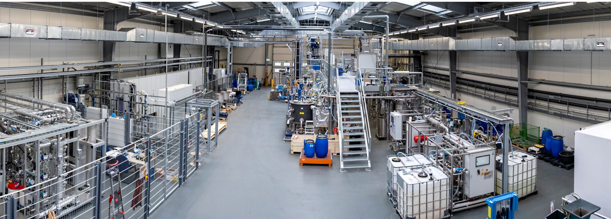
Abbildung 19: Pilotanlage zur Herstellung von erneuerbarem Methan auf dem Gelände des Deutschen Biomasseforschungszentrum gemeinnützige GmbH in Leipzig
