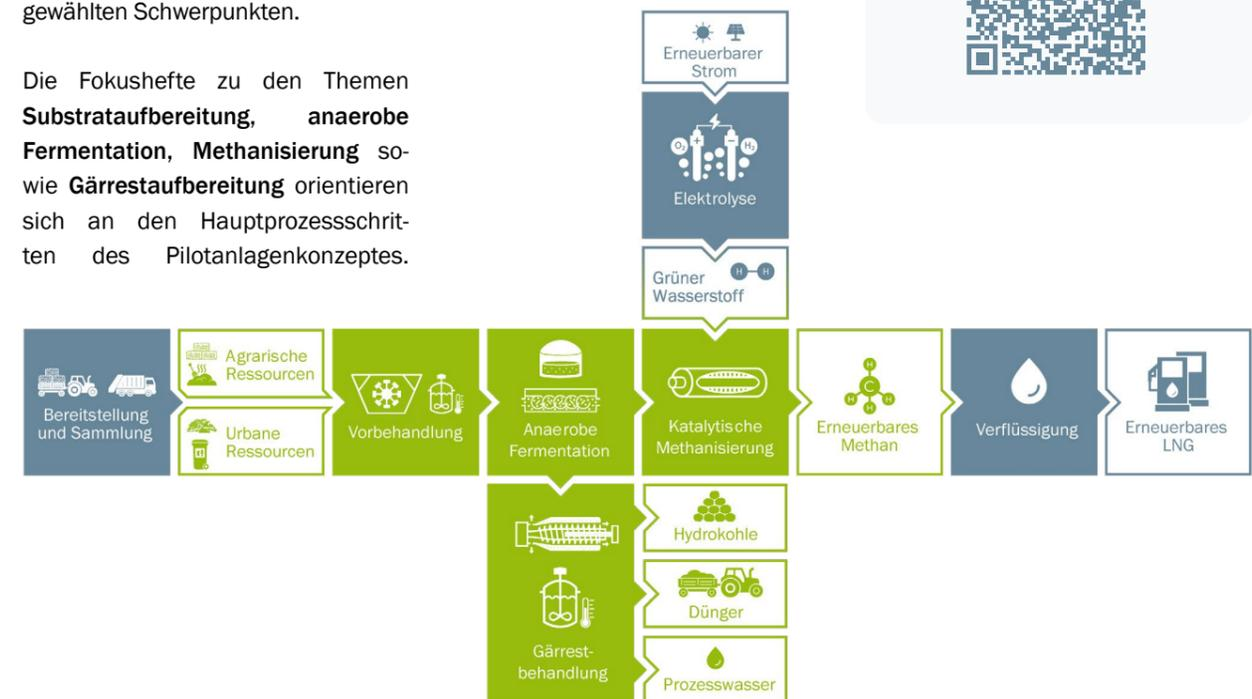
Abbildung 18: Prozessschritte in der Pilotanlage (grün) und Betrachtungsrahmen für den kommerziellen Maßstab (grün + petrol)
