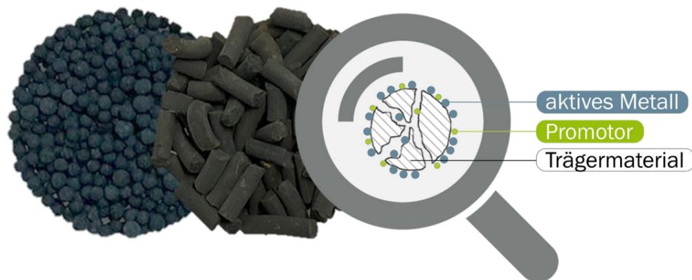
Abbildung 3: Aussehen und Aufbau eines Trägerkatalysators
