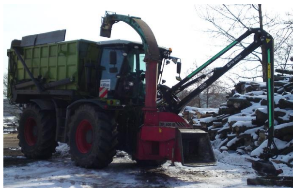
Angepasste Erntemaschine mit Hacker. Foto: DBFZ
