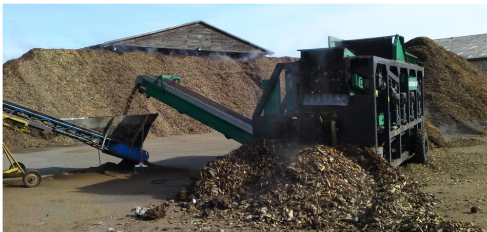
Abbildung 11: Hacker mit 3-Wege-Sternsieb am Biomassehof Borlinghausen. Foto: DBFZ
