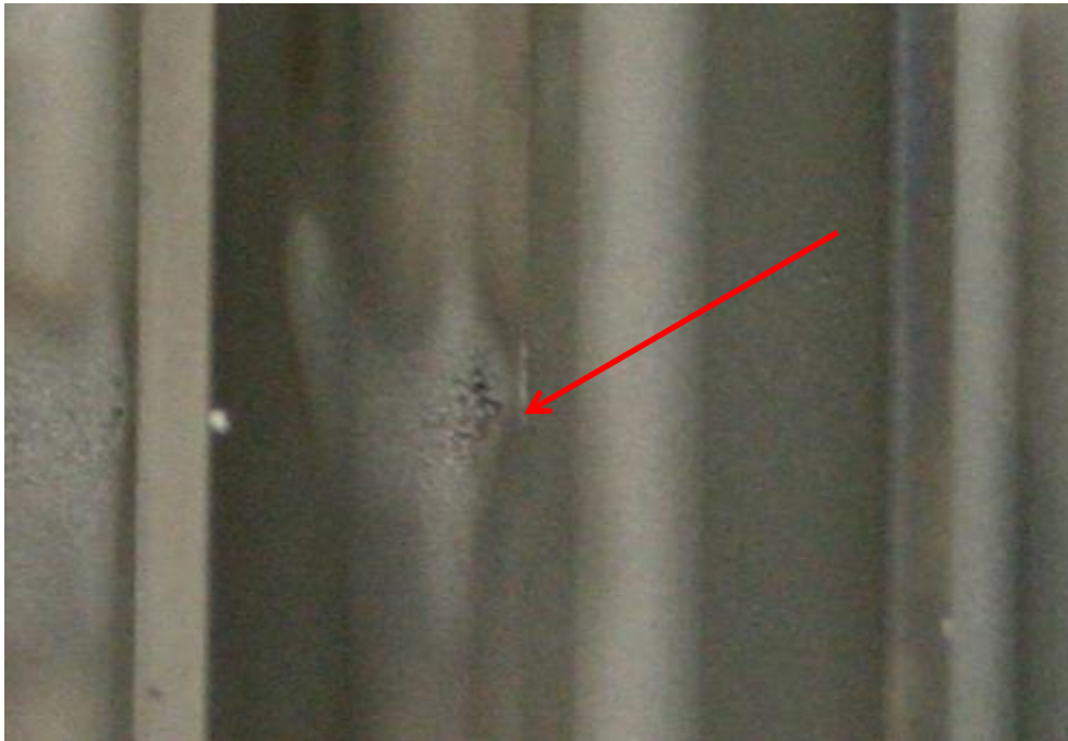
Abbildung 2.13: Impeller auf der mit konventionellem Kerosin betriebenen Seite: Deutliches Micropitting
