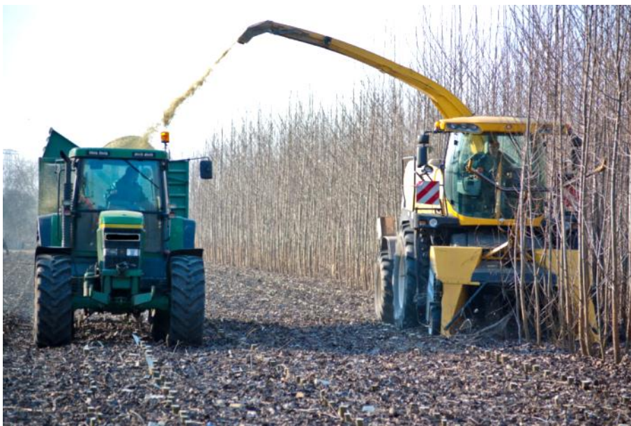
Abbildung 5.8: Ernte einer dreijährigen Pappelplantage mit Feldhäcksler inklusive Vorsatz für die Energieholzernte und parallel fahrenden Traktorzug 118
