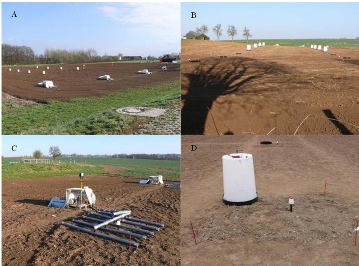
Abbildung 4-6: Feldversuch auf der Parzellenanlage: A und B-Blick über die Gesamtanlage; C-Kalibrierfelder für NH<sub>3</sub>-Bestimmung; D-Probenahme NH<sub>3</sub>(Passivsammler) und CH<sub>4</sub>/N<sub>2</sub>O (Haube).
