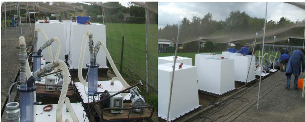
Abbildung 4-4: Gleichzeitige Probenahme von Methan, Lachgas und Ammoniak während der ersten Versuchswoche.
