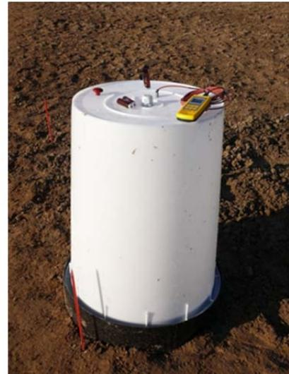
Abbildung 4-8: Haubensystem zur Methan- und Lachgasmessung mit Wassertasse. Foto: Messdurchgang auf der Parzellenanlage. Skizze: Aufbauskitze
