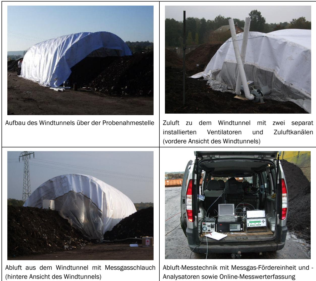
Abbildung 5-2: Emissionsmessungen mit der Tunnel-Messmethode (Windtunnel) an offenen Kompostierungsanlagen (gewitra 2012).
