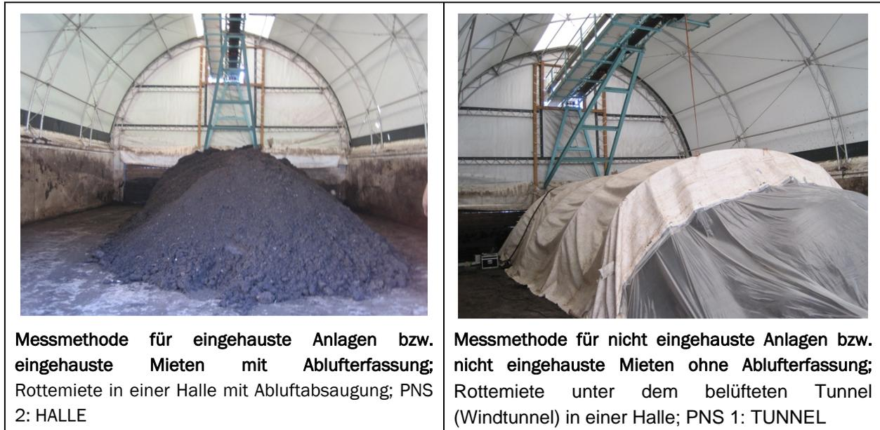
Abbildung 5-3: Emissionsmessungen zum Vergleich bzw. Abgleich der Messmethoden für eingehauste Anlagen (Halle) und nicht eingehauste Anlagen (Windtunnel). (gewitra 2012)
