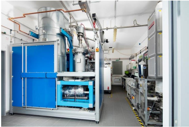
Abbildung 1: DBFZ nimmt neue Versuchsanlage zur Untersuchung der Vorgänge bei der thermochemischen Umwandlung von Biomasse in Betrieb. Foto: © Jan Gutzeit/DBFZ
