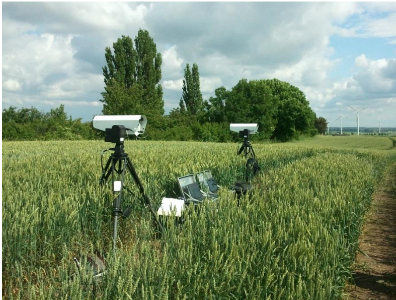
Laserspektrometer zur Messung der Methan- und Ammoniakkonzentration in der Umgebung von Biogasanlagen. Foto: © DBFZ
