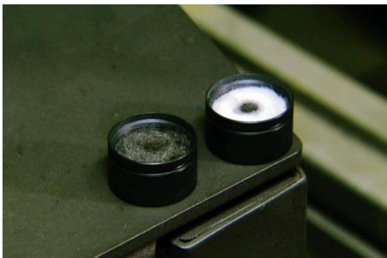
Abbildung 1: Vergleich der Rußfilter nach 30 Minuten Betrieb unter gleichen Testbedingungen: emissionsarmer Kaminofen (links) und der Prototyp "Pellwood" (rechts). Bild: Maximus Film GmbH
