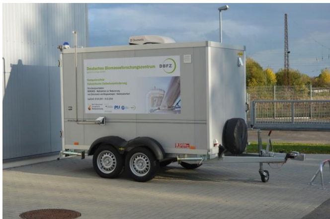
Abbildung: Mobile Anlage zum Testen der Katalysatoren gegen Methanschlupf an Biogasanlagen. © DBFZ
