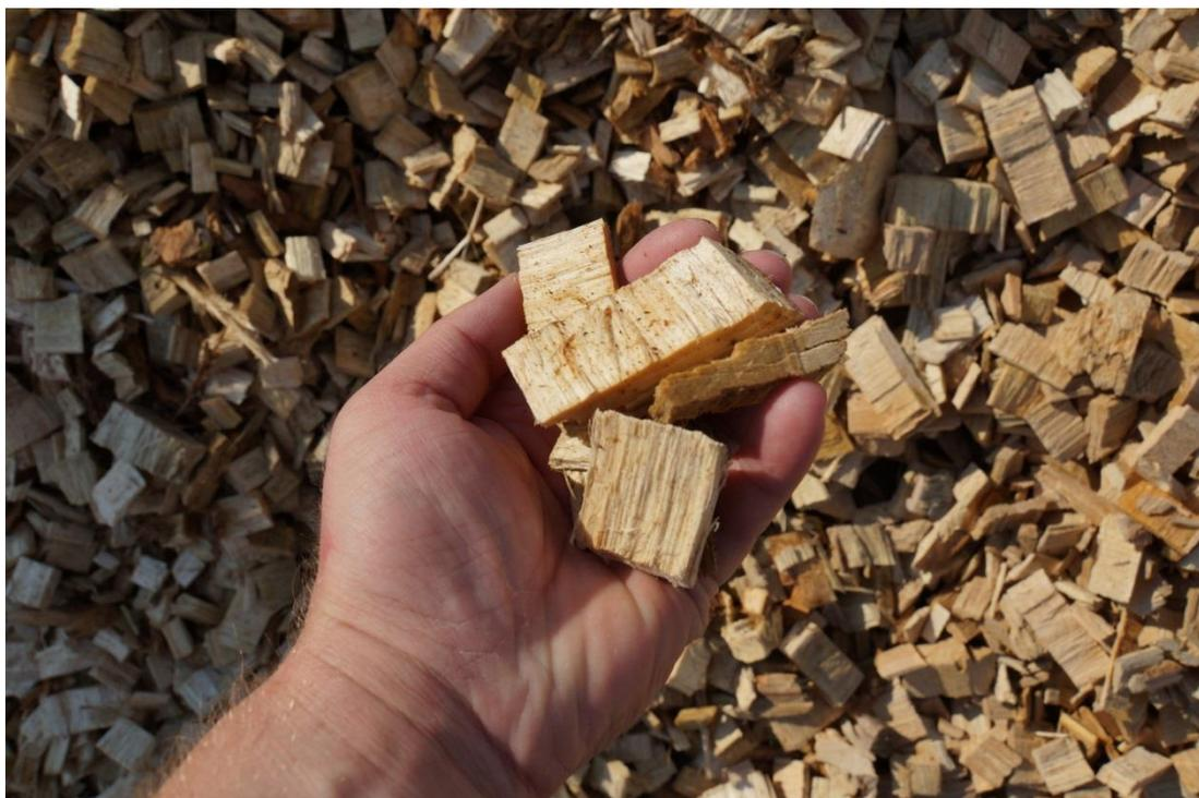
Qualitätshackschnitzel wirken sich positiv auf die Betriebsweise und das Emissionsverhalten der Feuerungsanlage aus. Foto: © DBFZ
