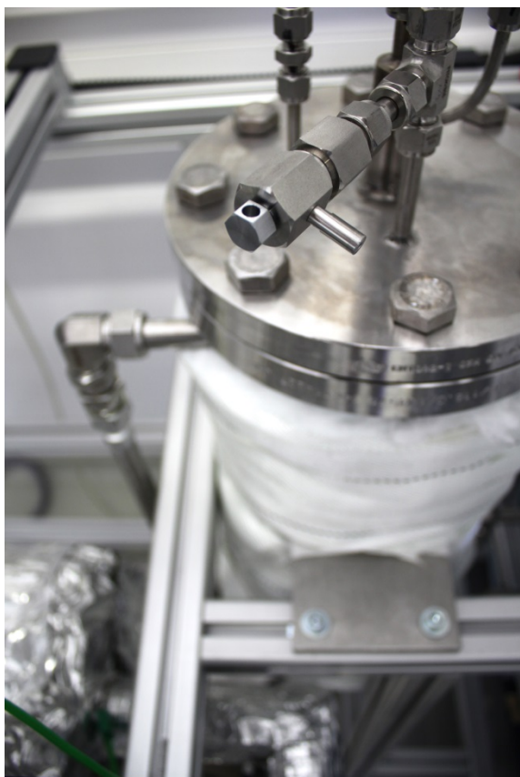
Thermoöl-gekühlter Synthesereaktor im Technikum des DBFZ. Bild: DBFZ
