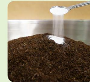
Mit der Zugabe von Presshilfsmitteln oder Additiven werden die mechanischen Eigenschaften der Presslinge verbessert bzw. die Verbrennungseigenschaften positiv beeinflusst.
