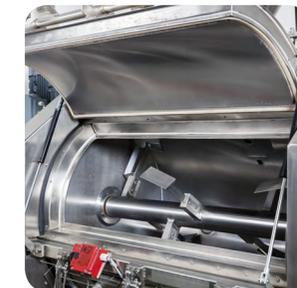
Der Schrägschaufelmischer verfügt über Feuchtesensoren, Temperaturmesstechnik sowie ein System zum Einbringen von Dampf und Flüssigkeit.
