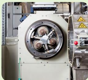
Biomassepellets können kontinuierlich, mit etwa 50 kg/h, mittels unserer 30kW Ringmatrizenpresse hergestellt werden.
