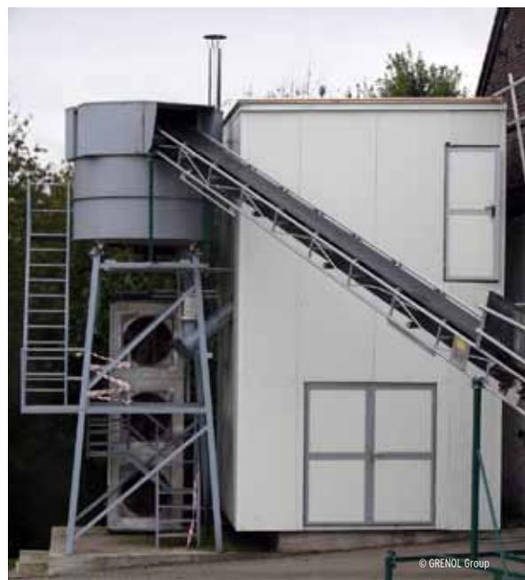
Abbildung 1: Holz-/ Kohle-Vergaser der Firma GRENOL zur Gewinnung von Strom und Wärme aus der produzierten Kohle.
