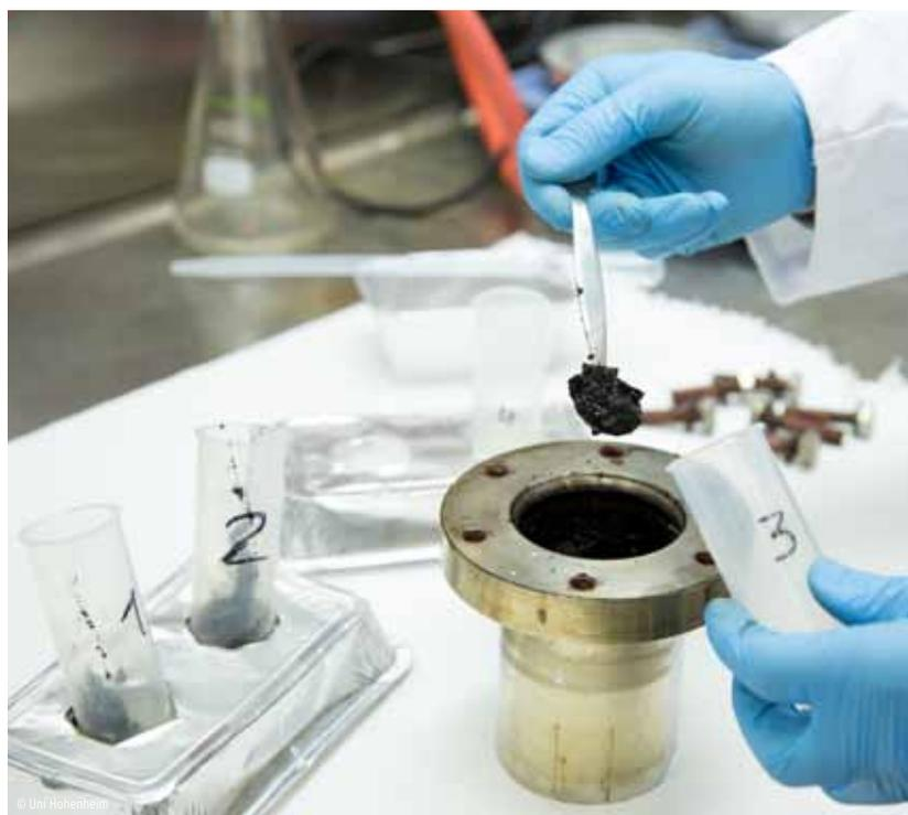
Koks umgewandelt, was hydrothermale Carbonisierung genannt wird. Eine Reaktion, die zu einem braunen oder schwarzen Material führt, das den Brennwert von Torf bzw. von Braunkohle besitzt, aber chemisch sich stark von diesen fossilen Materialien unterscheidet. Das „Aqueous Phase Reforming“ ist eine Methode, um aus wasserstoffreichen Substanzen, die aus Biomasse hergestellt werden können, Wasserstoff zu erzeugen.
