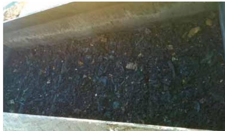
Die Speisereste nach ca. 3 h im Carbonisierungsbehälter. Die Menge ist durch die Wasserabtrennung geringer geworden. Der Brennwert liegt (waf) bei ca. 7 kWh/kg bzw. 25 MJ/kg.
