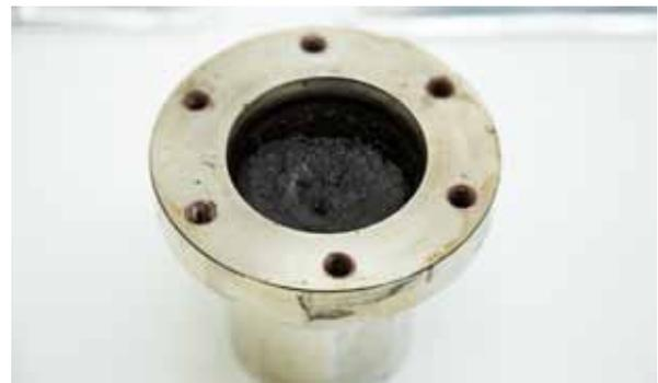
Abbildung 1: HTC-Autoklav mit nasser HTC-Kohle
