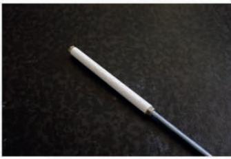
**Abb. 3**  $\text{Al}_2\text{O}_3$  Röhren nach Beschichtung
