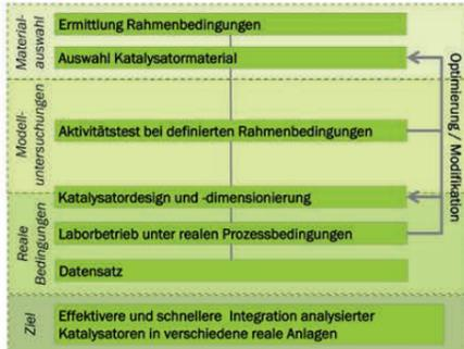
**Abb. 1:** Vorgehensweise zur anwendungsspezifischen Charakterisierung von Katalysatorproben für Biomasse-Kleinfeuerungen
