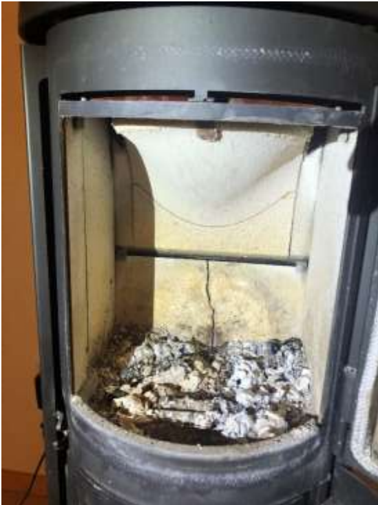
Defekte Schamottauskleidung → dringend auszutauschen!
