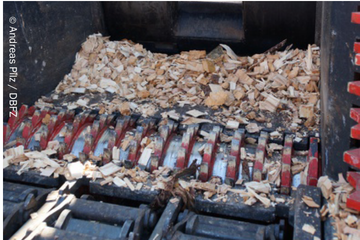
Ein Holzacker für die Zerkleinerung von Altholz.
