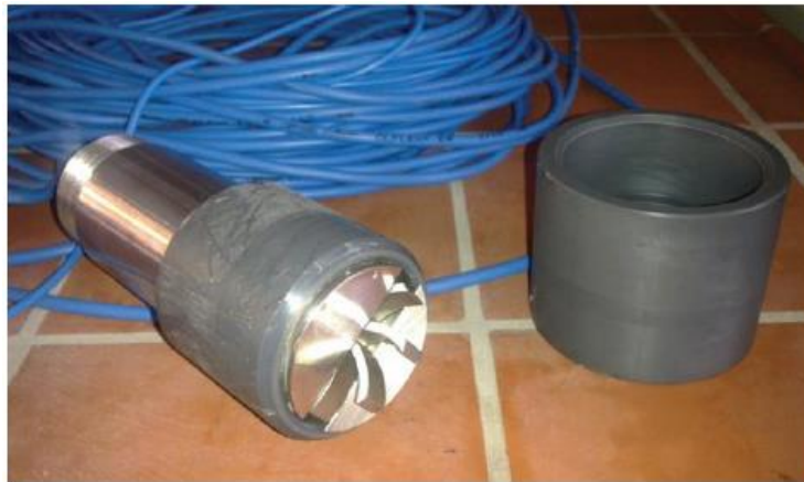
图 49：叶片测速仪的传感器端，可用于测量工业级沼气发酵设备中的速度；由弗劳恩霍夫环境、安全和能源技术研究所制造（资料来源：柏林工业大学）
