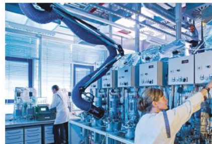
图 73: 弗劳恩霍夫陶瓷技术和系统研究所的实验室厌氧消化装置
