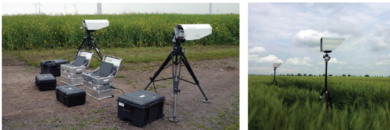
图 21b: 左侧为激光光谱仪, 右侧为反射模块 (资料来源: 德国生物质研究中心)
