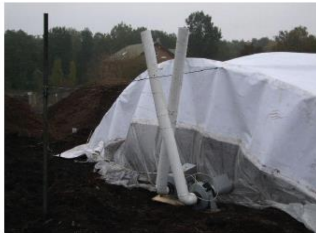
使用两个独立安装的风扇和供气管路将环境空气鼓入风洞中 (风洞前视图)
