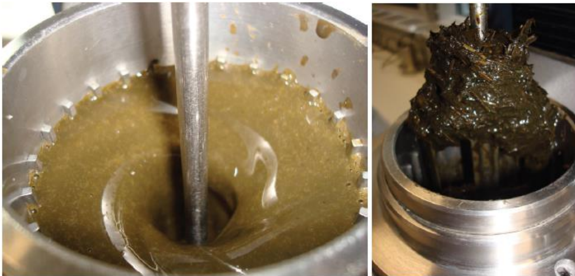
图 42: 因产生涡流和长纤维组分缠绕搅拌器轴而导致的测量误差 (资料来源: 陶瓷技术和系统研究所)
