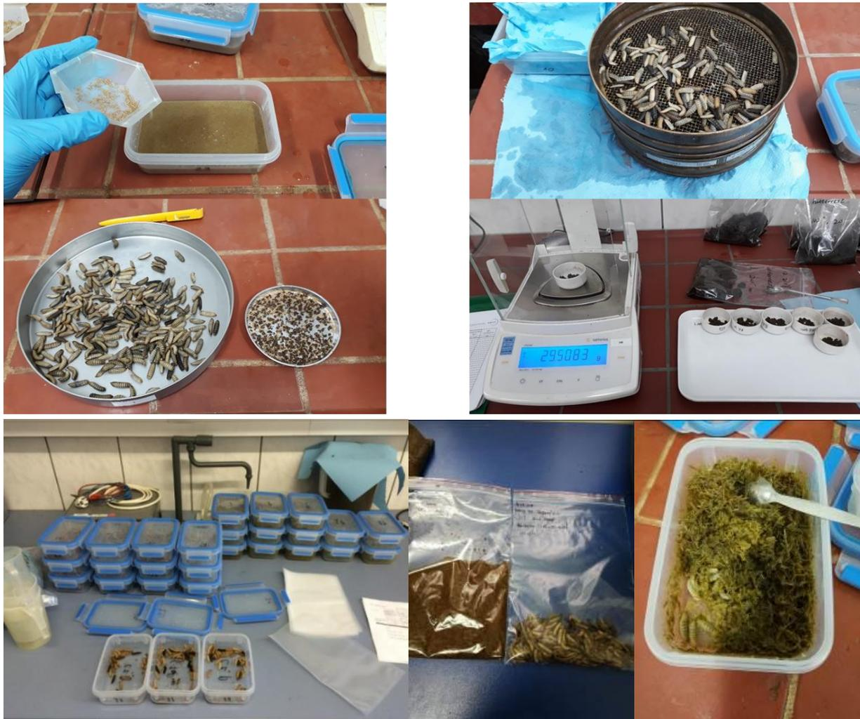
Abbildung 4: Geräte für die Bestimmung des Einzelgewichtes der Larven und Trennung der Futterreste und Larven
