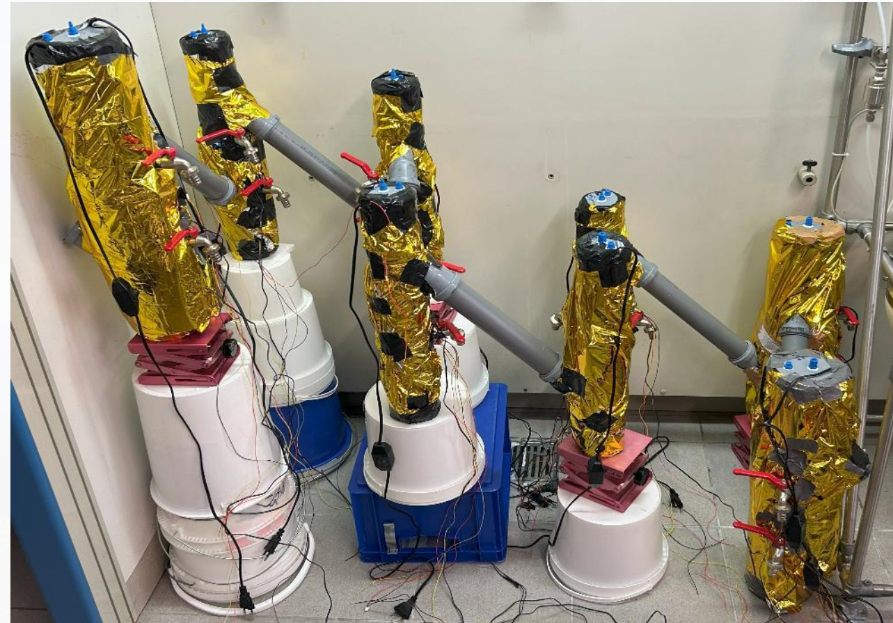
Fig 5: Assembled 17 L 8-Chamber ABR
