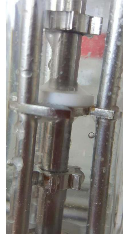
Benetzung der Einbauten durch die disperse Phase an den Einbauten aus Edelstahl.
