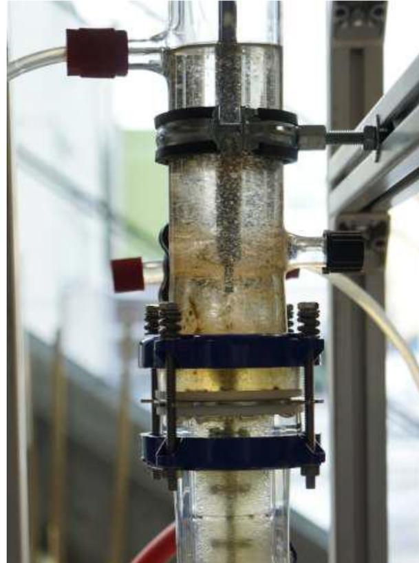
Koaleszenz der Tropfen der leichten Phase in dem Kopfraum der DN30 Kolonne
