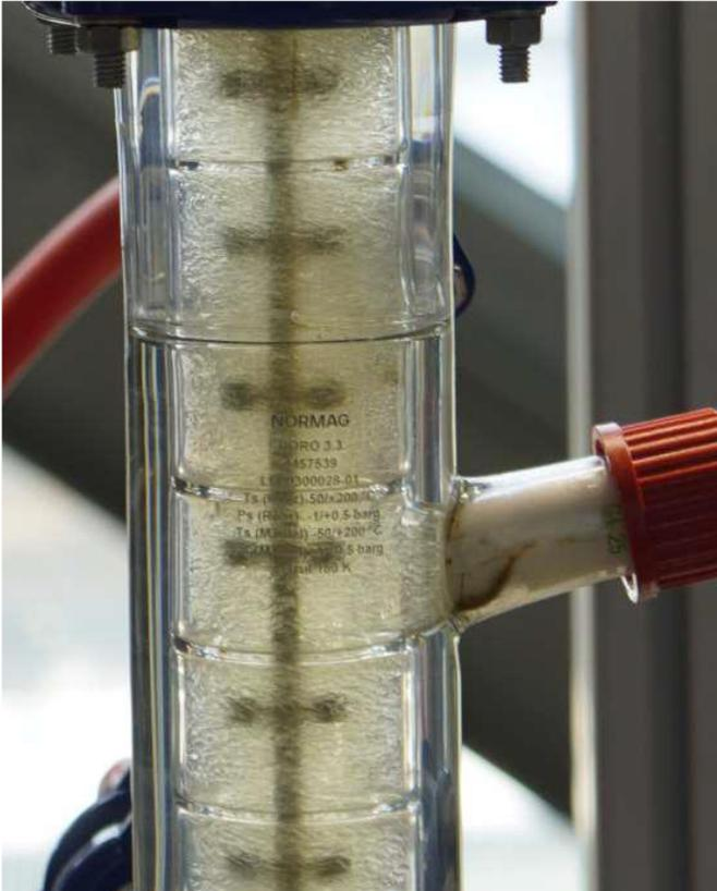
Durchmischung kleiner Tröpfchen in der DN30 Kolonne bei 500 rpm.
