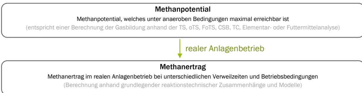
Abbildung 1: Zusammenhang zwischen dem Methanpotential und Methanertrag im realen Anlagenbetrieb
