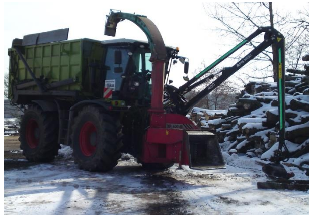
Angepasste Erntemaschine mit Hacker. Foto: DBFZ
