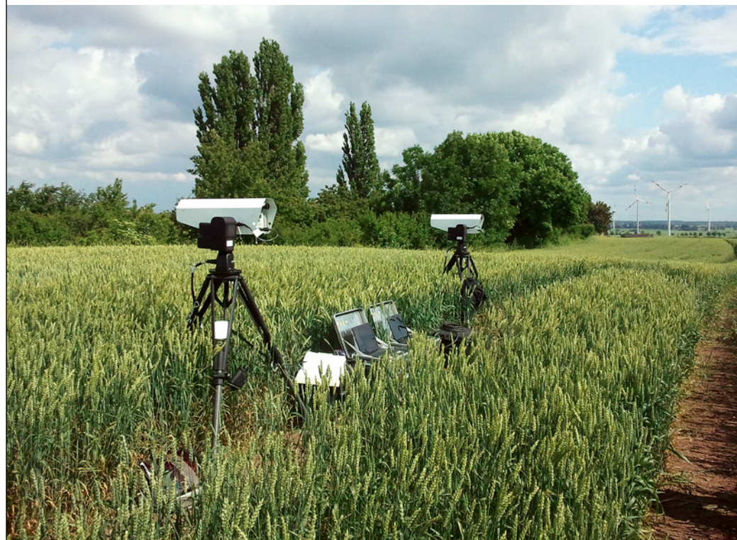
Abb. 53 Emissionsmessungen im Feld
