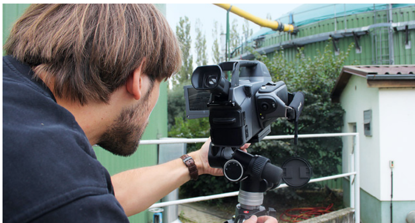
Abb. 5 Leckagesuche an einer Biogasanlage
