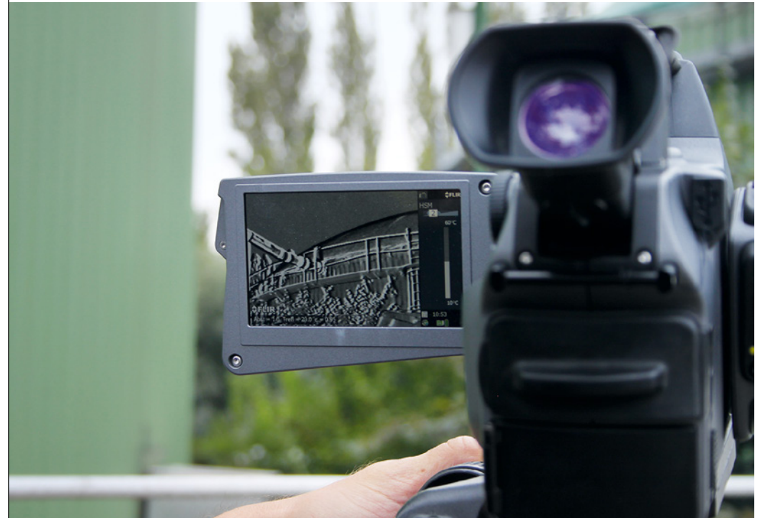
Abb. 9 Methandetektion an einer Biogasanlage
