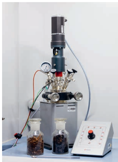
Abb. 52 500 ml Batch-Reaktor mit Rührer im Kraftstofftechnikum des DBFZ
