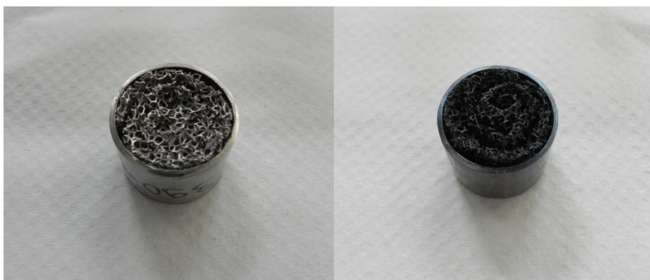
Abbildung 11: Probe mit Edelmetalldotierung (Palladium) bei Anlieferung von der Fa. Wieland Edelmetalle (links) und nach der Durchführung der Aktivitätstests im Modellgas (rechts)
