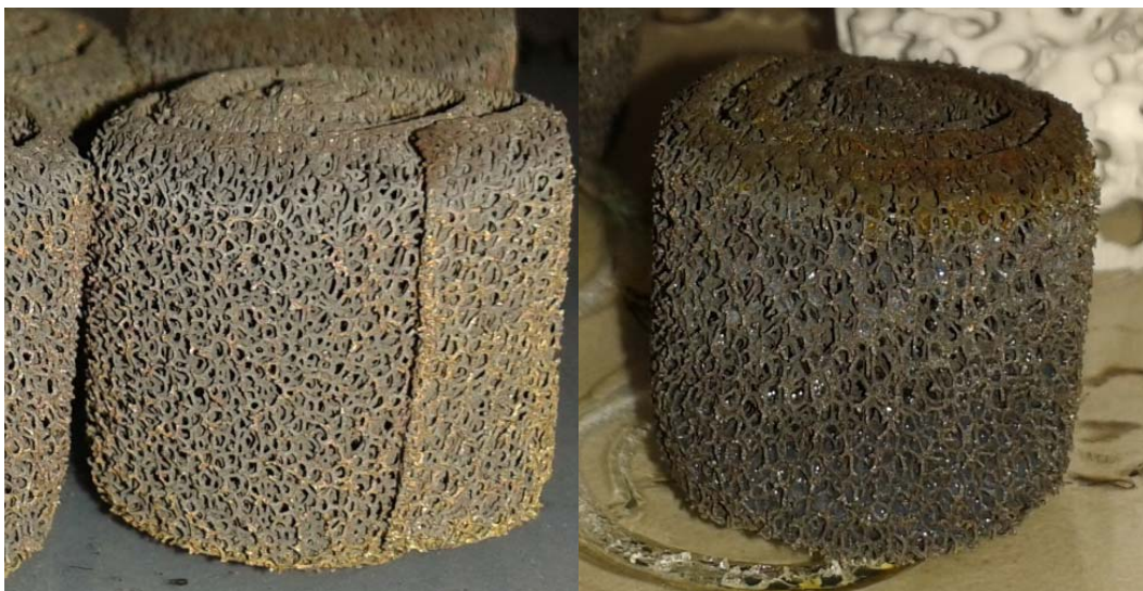
Abbildung 13: FeCrAl-Metallschaumprobe nach Erzeugung der Oxidschicht aus dem Material (links) und nach dem Tauchen der Probe in Böhmitlösung (Disperal) mit anschließender Trocknung (rechts)
