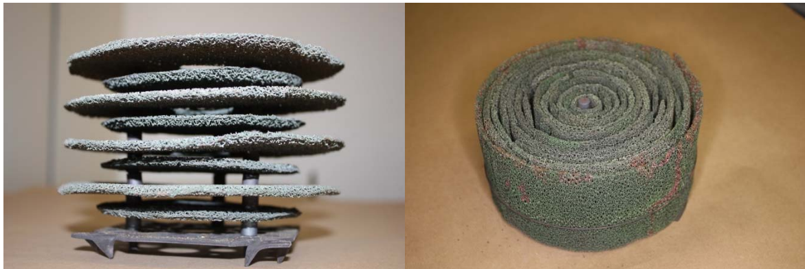
Abbildung 28: Monolithstrukturen aus Metallschaum zur Prüfung des damit erzeugten Druckverlustes in der Nachrüstlösung: Übereinandergeschichtete Scheiben (links) und konzentrische Kreise (rechts)
