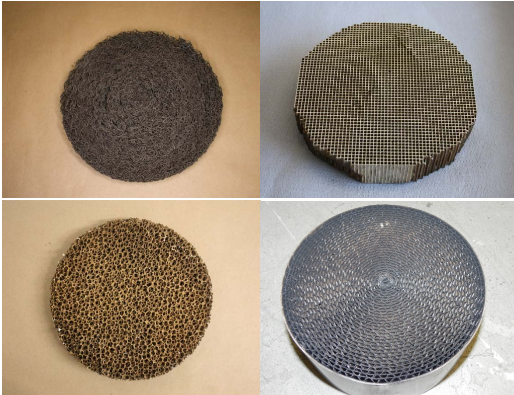
Abbildung 3: In der Nachrüstlösung eingesetzte kommerziell verfügbare Katalysatoren: Drahtgestrick (oben links), Wabenkörper (oben rechts), Schaumkeramik (unten links) und Metallwabe (unten rechts)
