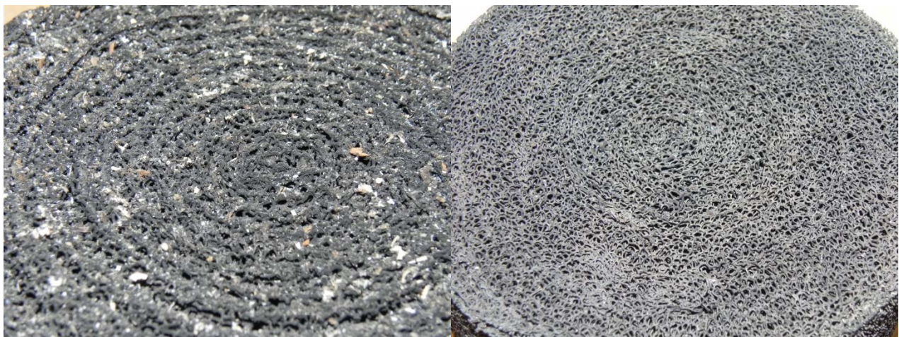
Abbildung 34: Unterseite (angeströmte Seite, Abbildung links) und Oberseite (Seite stromabwärts, Abbildung rechts) des Katalysators nach dem Einsatz in der Nachröstlösung mit Betrieb des Kaminofens Justus
