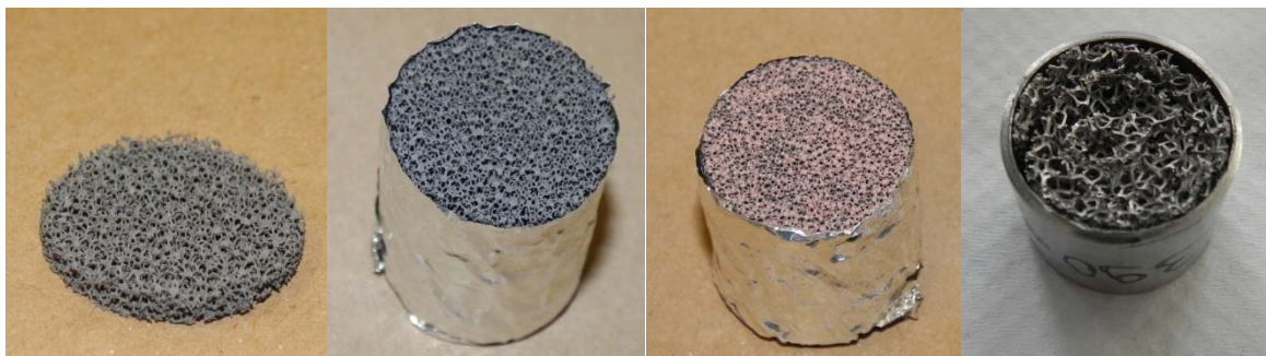
Abbildung 4: Einzelne Metallschaumplatte (links) und eingesetzter Monolith aus dem Metallschaum mit Edelmetall-Washcoat Probe 2.2 (2.v.links), Monolith aus Metallschaum mit Eisenzeolith-Washcoat (2.v.rechts) und spiralförmig aufgewickelter Metallschaum mit elektrolyt. Edelmetalldotierung (rechts)
